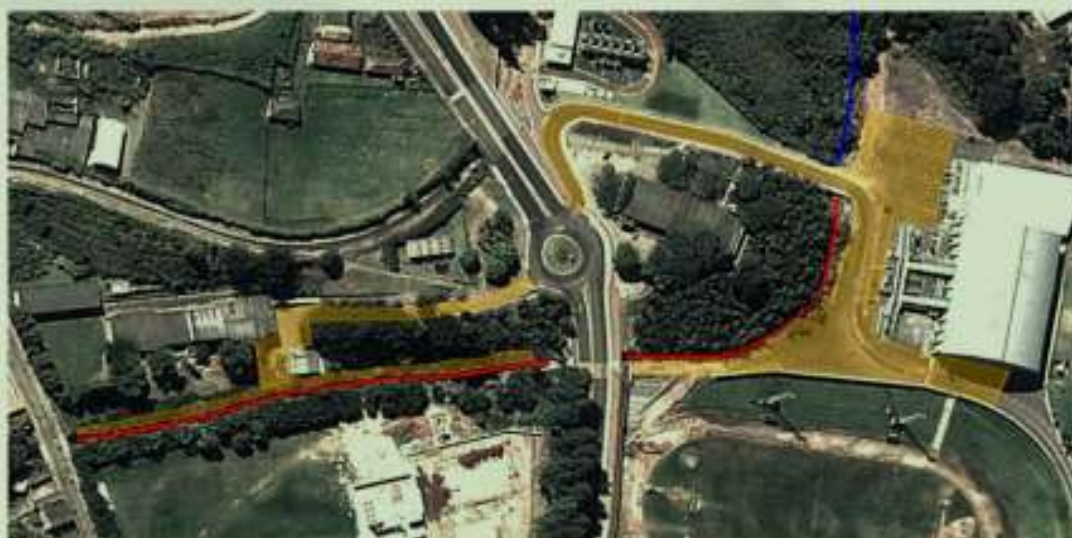
Figura 2. Localização e disposição das áreas de tráfego de maquinários para a realização das obras de canalização do Ribeirão Vermelho. Fonte: Google Earth® (2013).
