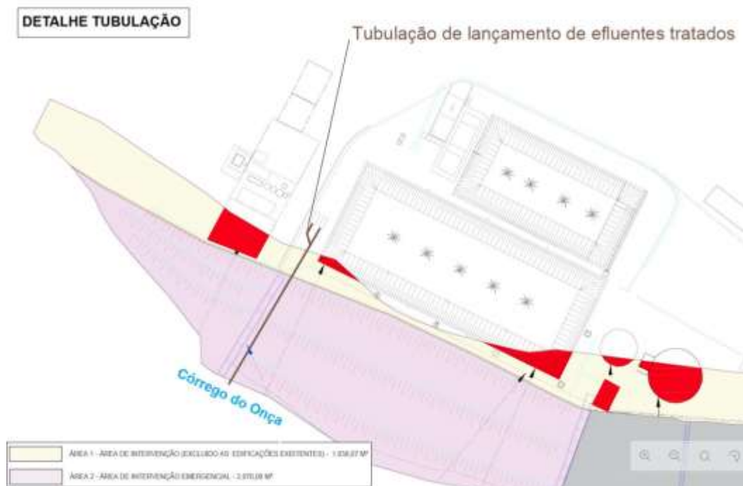
Detalhe da tubulação de lançamento de efluentes tratados no Córrego do Onça.
