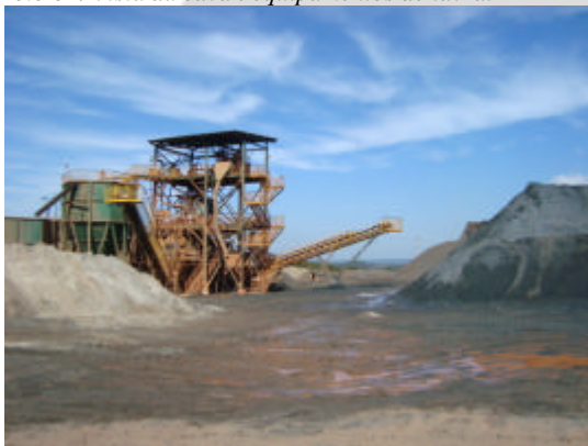
Foto 03. UTM utilizada no beneficiamento do minério de ferro.
