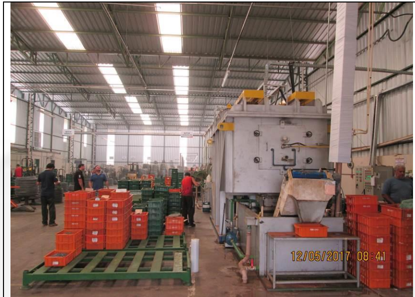
Foto 1: vista geral da fabricação de parafusos com o forno de cementação em primeiro plano e os rolos de arame BTC ao fundo
