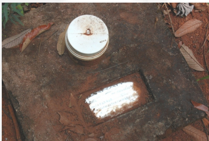
Figura 4: Marco de furo de sonda após pesquisa concluída (local modelo).
