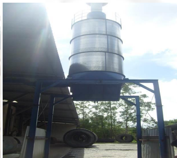
Foto 6: Silo de armazenamento das aparas de borracha.
