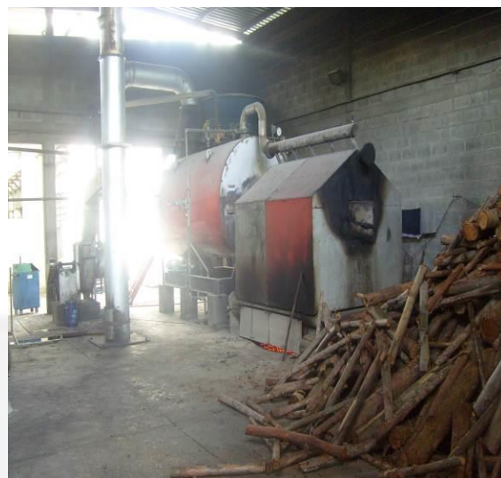
Foto 14: Caldeira utilizada no processo de geração de vapor.
