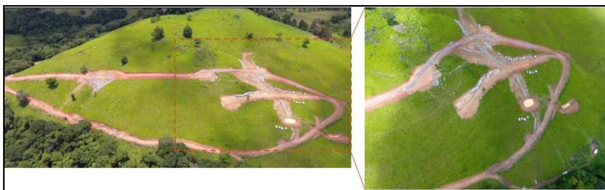
Figura 15: Sistema de drenagem interna realizado na pilha.
