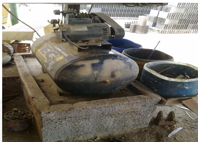
Foto 06. Compressor com bacia de contenção
