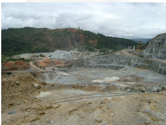
Foto 05. Vista da planta de britagem (ao meio) e cava desenvolvida em meia encosta.
