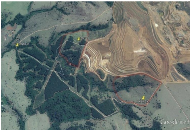
Figura 01 – Imagem da área do empreendimento em licenciamento e áreas florestais que necessitam ser erradicadas para sua instalação. À direita da foto, o atual depósito de estéril da empresa, SW-Fase 2 ou ‘Dora Lemos’, e nos polígonos em vermelho, as expansões do mesmo denominadas fases 2A e 2B.
