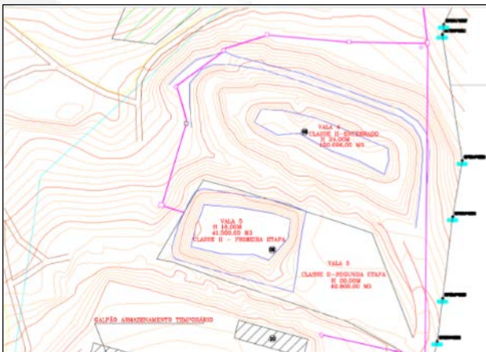
Figura 6 – Situação atual em planta das células (valas 4 e 5) do aterro de resíduos não perigosos Classe IIA e IIB. Fonte: Figura 07 do Relatório Técnico acostado no processo.
