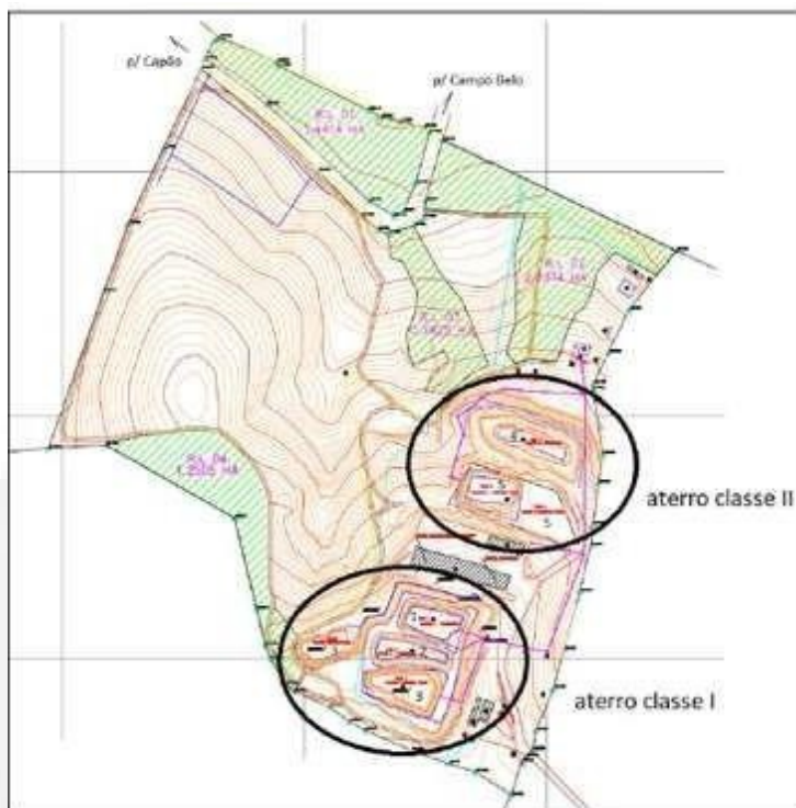
Figura 8 – Planta planialtimétrica do empreendimento. Fonte: PU nº 066/2022, PA SLA nº 4921/2021.
