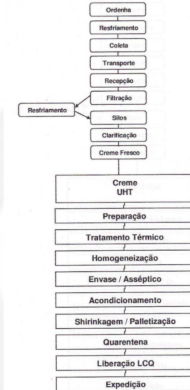
Figura 4: Fluxograma do Processo de Fabricação de Creme de leite – UHT.
