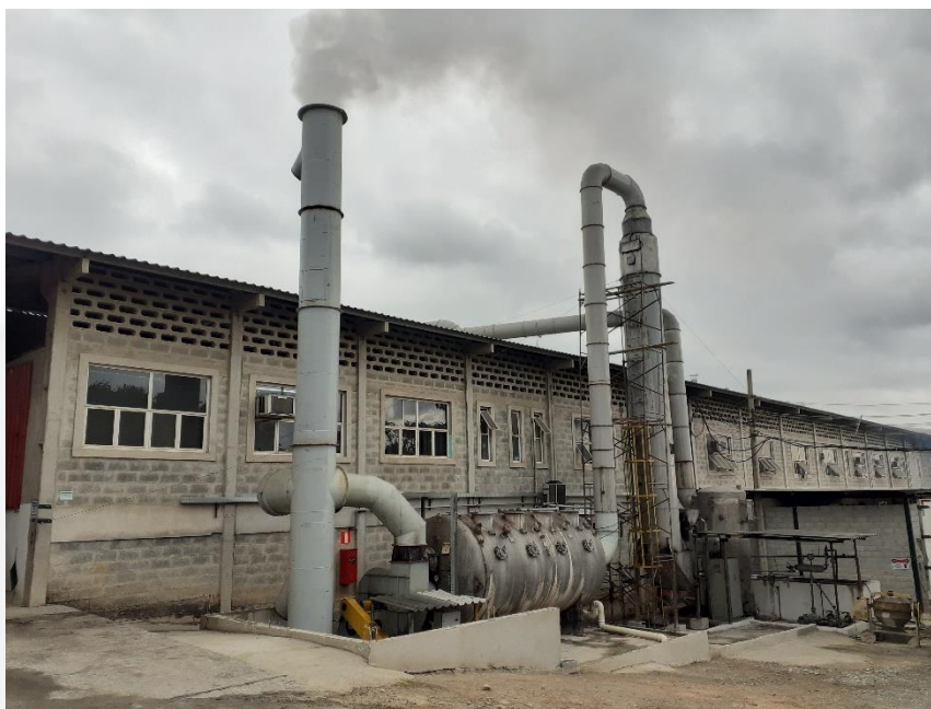
Figura 01: Emissão de névoa proveniente da chaminé única após modificação do sistema de mitigação dos efluentes atmosféricos. Fonte: Vistoria – 21/08/2020.
