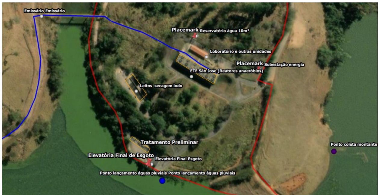
Figura 2: Vista aérea das estruturas da ETE São José com tratamento preliminar, elevatória final de esgoto, reatores anaeróbios, leitos de secagem, laboratório, reservatório de água, emissários, ponto de lançamento de água pluvial e ponto de monitoramento de coleta a montante.
