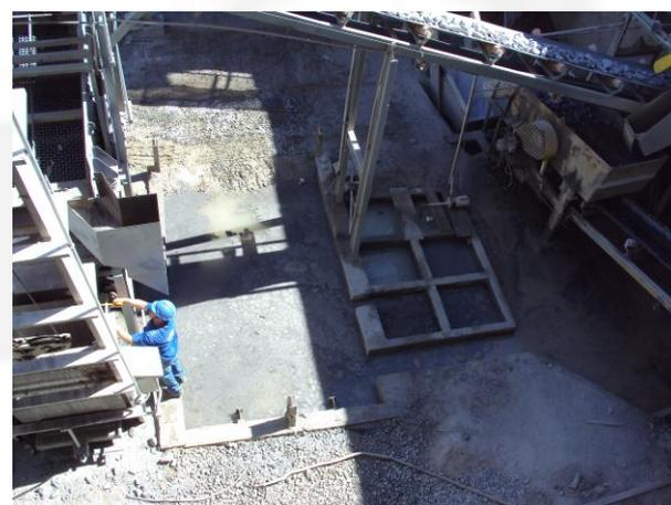
**Foto 6.** Bacia de sedimentação utilizada para reutilização da água na aspersão do calcário
