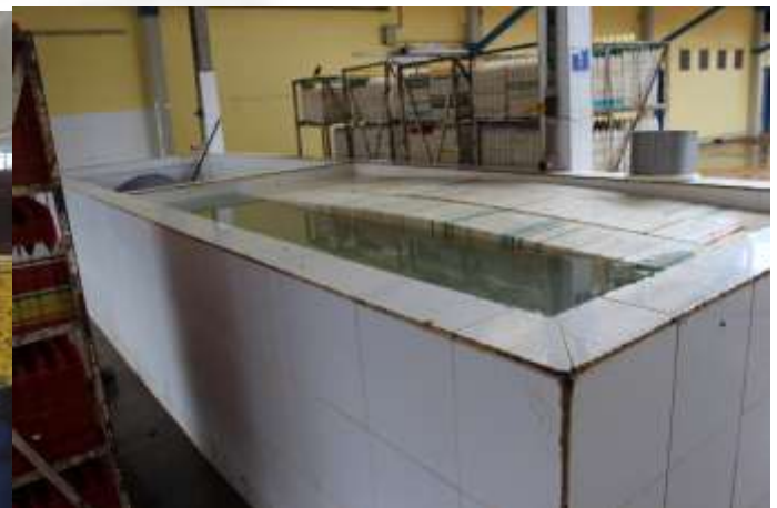
Foto30: Tanque de desinfecção dos pentes de ovos contendo solução de hipoclorito de sódio.
