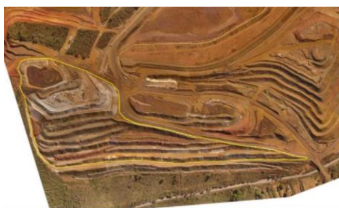
Figura 12.4: Áreas para recebimento da camada de topsoil . À esquerda PDE ECWOES e a direita Barragem Samambaia. Fonte: Informação complementar.
