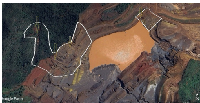
Figura 17 - Demonstração do avanço do processo de deslizamento das bancadas na divisa entre o Parque Florestal Estadual da baleia e a EMPABRA.
