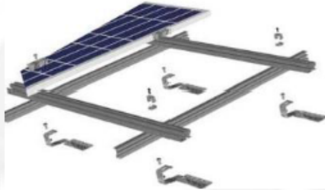
Figura 7: Montagem das hastes de suporte dos painéis. Fonte: RCA do empreendimento.
