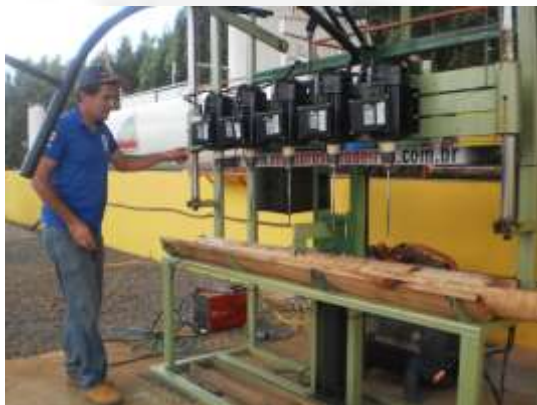
Foto 09 Equipamento p/ furar os troncos
