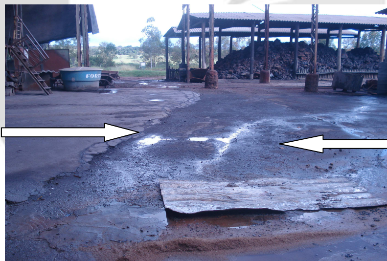
Fig: 05 Efluente sobre o solo, solução ácida de baterias em associação com águas pluviais e coloração cinza metálica sobre solo
