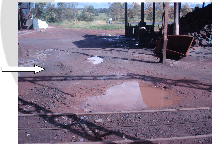
fig03: Efluentes sobre o solo, cor acinzentada (chumbo)
