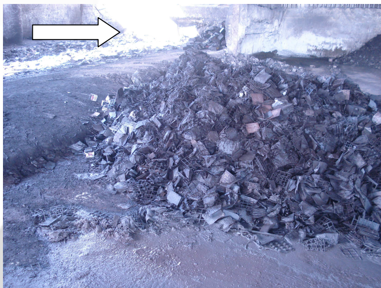
Fig 02: Efluentes percolando em sentido a áreas externas
