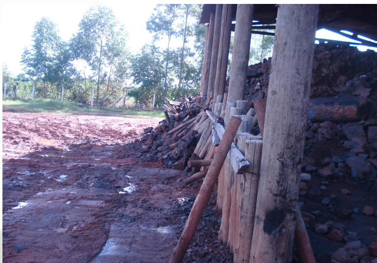
Fig 06: Armazenamento inadequado de escória de fundição de chumbo, exposição de escória de chumbo ao solo, contato com águas pluviais
