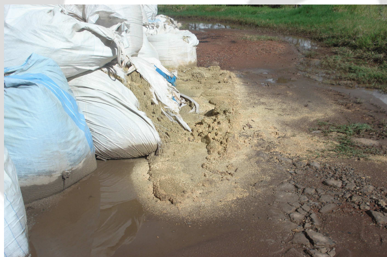
Fig 09: Armazenagem inadequada de lodo de ETE
