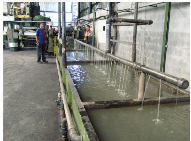
Foto 10. Tanque utilizado na fabricação de bandas. Ressalta-se que a água é recirculada.
