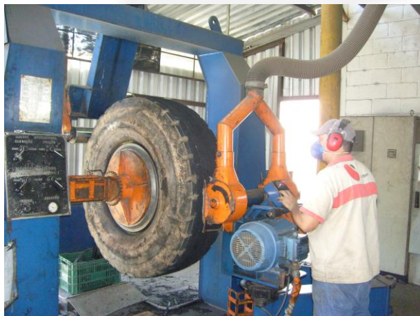
Foto 05. Escarificação de pneus com sistema de exaustão para o silo
