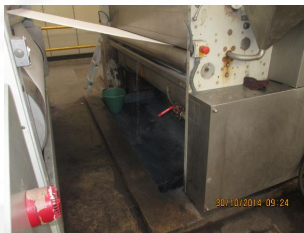
Fig.18 – Contenção existente nas máquinas, com ligação direta à ETE.
