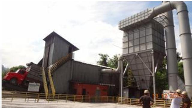
**Foto 02.** Sistema de descarga dos caminhões de carvão vegetal, à direita Filtro de Manga.
