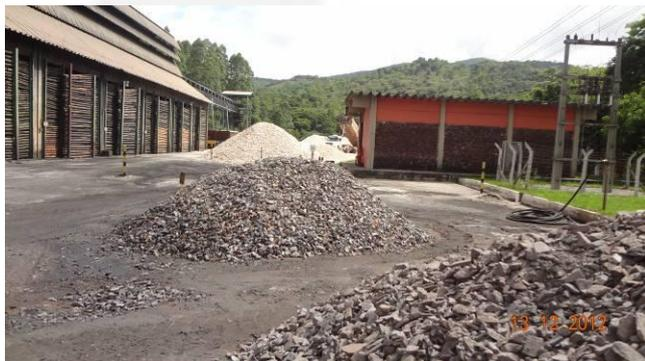
**Foto 03.** Pátio de estocagem das matérias-primas, à esquerda encontram-se as baias para armazenamento de carvão vegetal e à direita subestação de energia.
