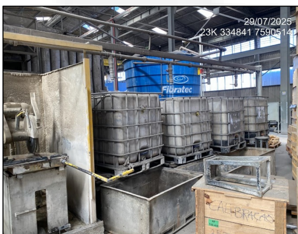
FOTO 5 – Sistema de recirculação do efluente das retíficas.
