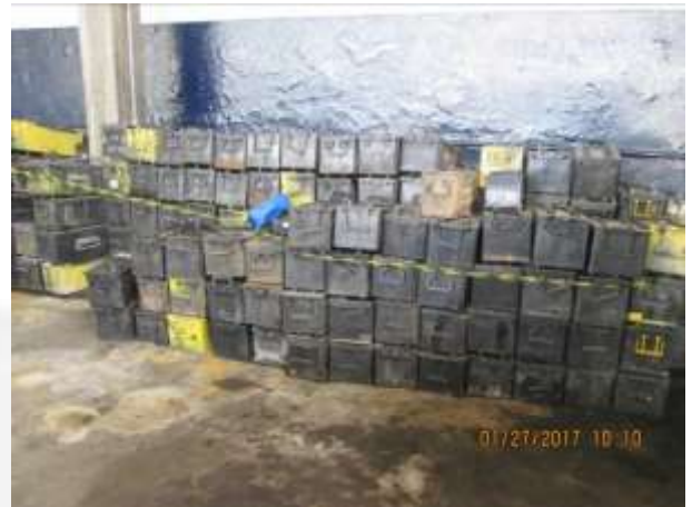
Foto 6 – baterias sendo armazenadas em local inadequado.
