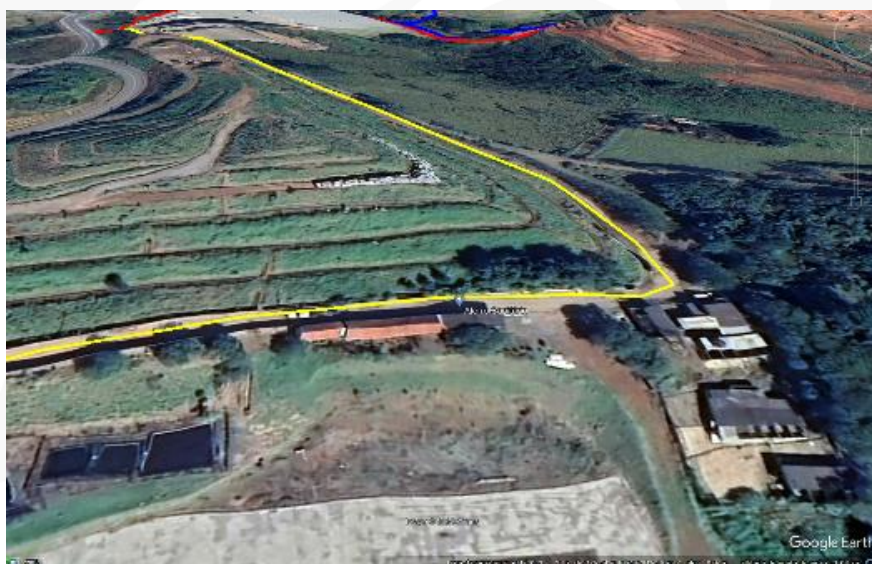
Figura 11 - Raio de Curva impossibilitando a manobra de carretas
