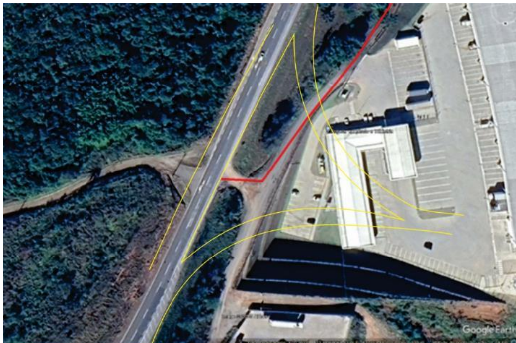
Figura 13 - Simulação de implantação de trevo nos padrões DNIT. Acesso irregular, sem pista de desaceleração, em declive e com curva de 90°.
