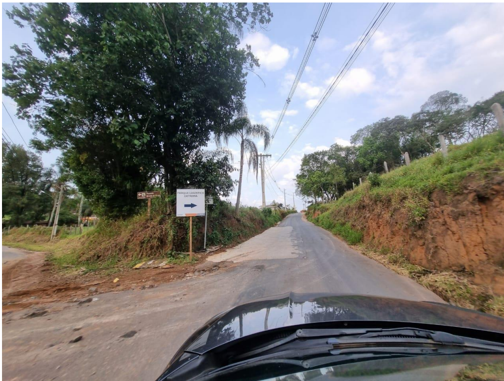
Figura 32 - Última rua de acesso alternativo, com grande inclinação, sendo superior à permitida para grandes caminhões.
