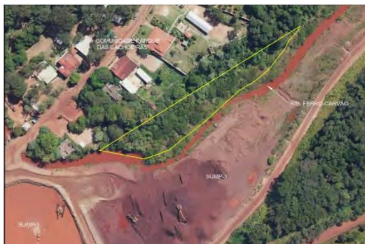
Figura 19 - Sumps de dragagem a montante do reservatório da EP-01, com destaque para a poligonal, em amarelo, à esquerda do sump-03. Fonte: PCIA Projetos Diversos, Vale 2024.
