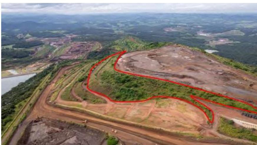
Figura 23 - Talude leste da PDE Menezes III onde ocorreu o crescimento de indivíduos arbóreos sobre o rejeito depositado na pilha. Fonte: PIA adequação da drenagem DTR-05 e Anexo e Remoção de Rejeitos na Pilha de Depósito de Estéril (PDE Menezes III. Vale, 2024.
