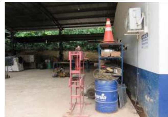
Foto 1: Oficina mecânica e elétrica com piso impermeabilizado
