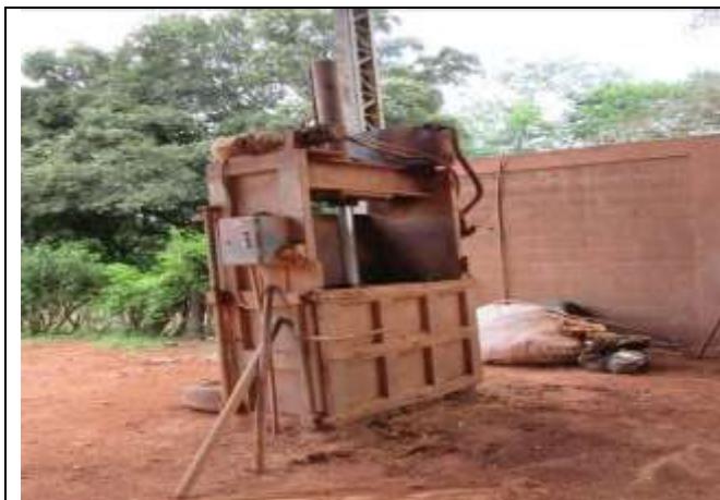
Foto 11: Prensa que comprime os big bags para ensacar a bauxita
