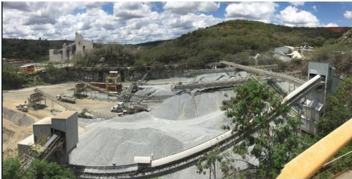
Figura 2.2.1.1.1. Linha de britagem de calcário.
