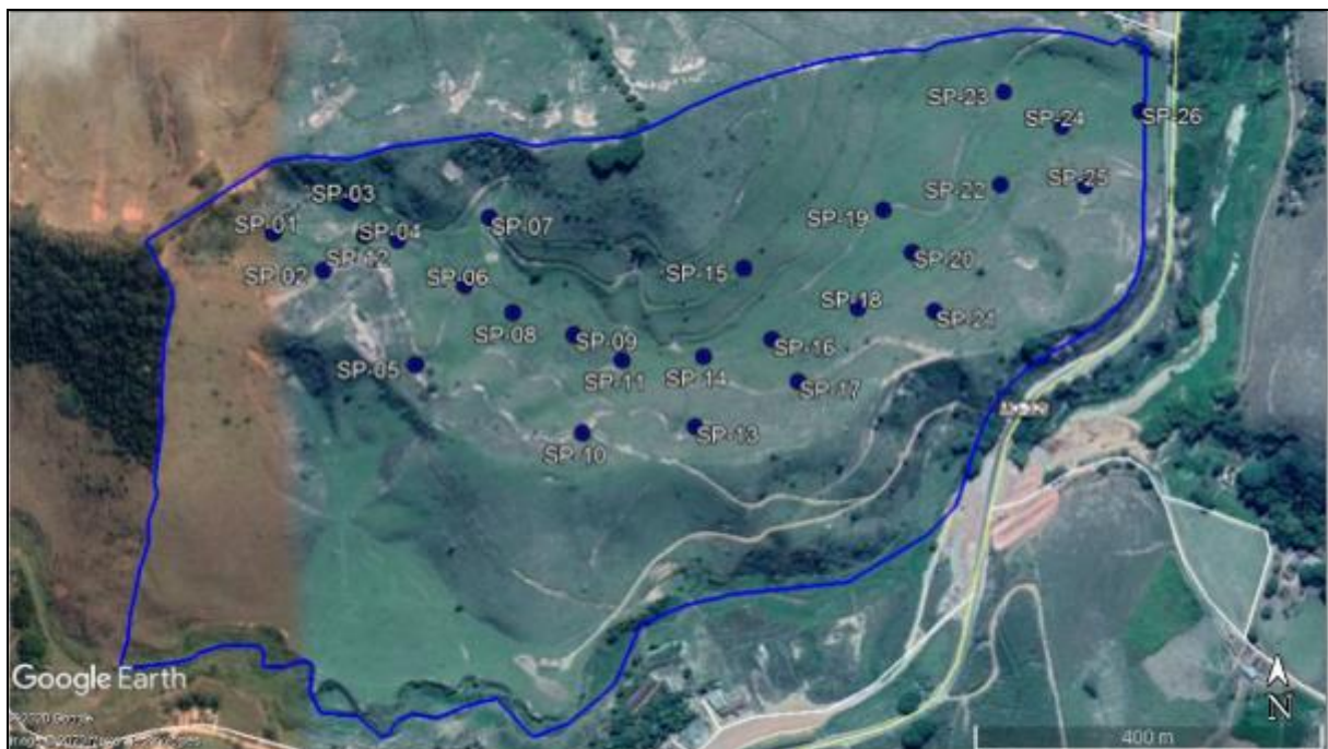
Figura 3: Planta de localização dos furos de sondagem a percussão SPT (furos SP) executados na área. Fonte: PCA CTR BITURUNA.
