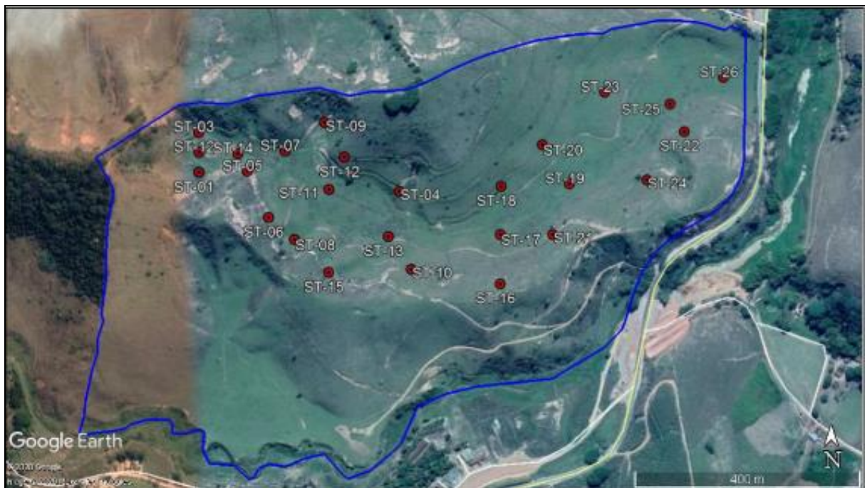
Figura 5: Planta de localização dos furos a trado (furos ST) executados na área. Fonte: PCA CTR BITURUNA.
