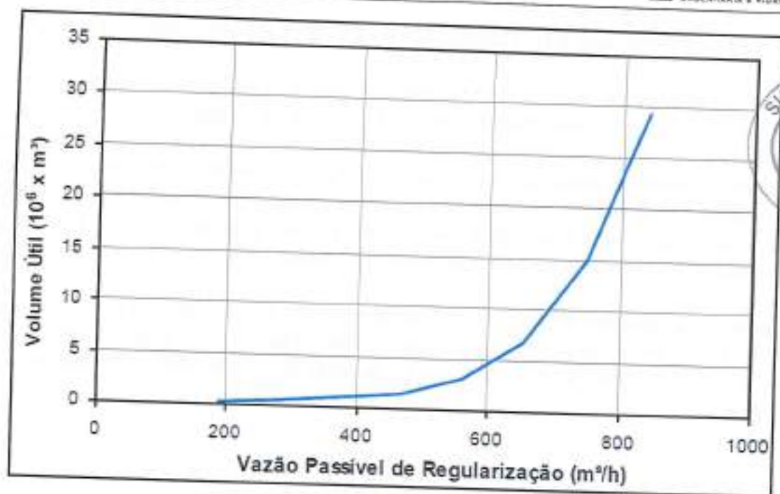
Figura 4.3 – Curva de regularização do reservatório da Barragem de Rejeitos (Fonte: VOGBR, 2009).
