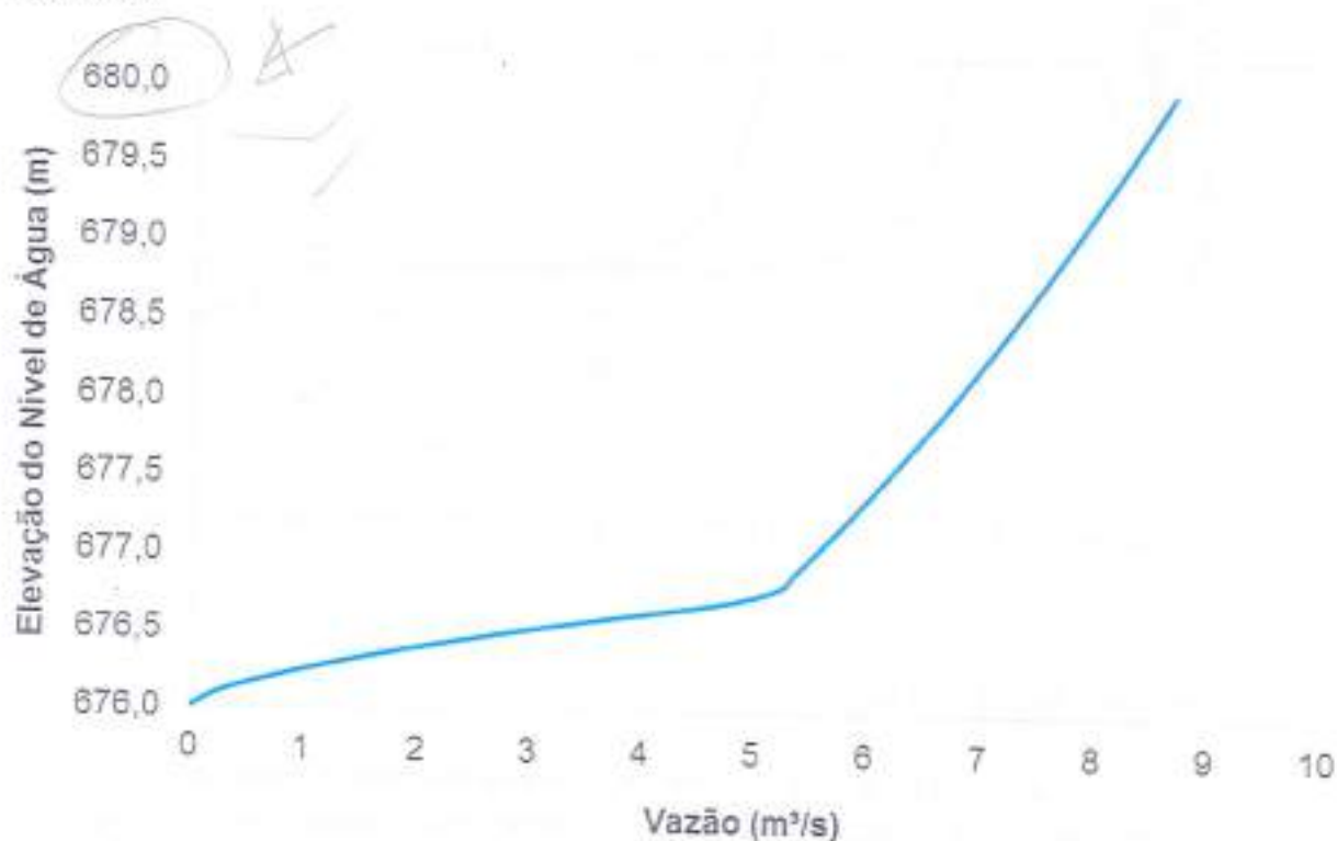
Figura 5.1 – Curva de descarga do sistema extravasor.
