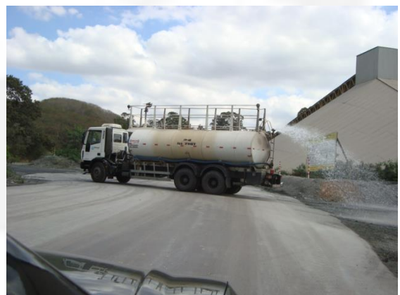
Foto 06. Caminhão-pipa utilizado na umectação das vias internas.
