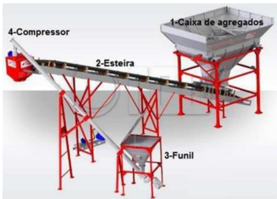
Figura 18. Sistema de funcionamento da central dosadora de concreto móvel.
