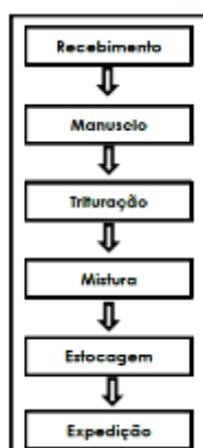
Figura 01: Etapas de processamento dos combustíveis alternativos. Fonte: PCA, 2015.
