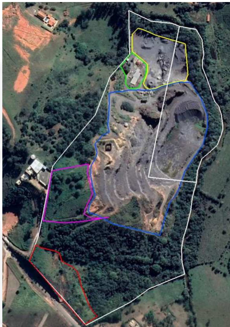
Figura 02: Localização da pilha de estéril (em vermelho), mina e suas estradas de acesso (em azul), ampliação da lavra (em magenta), pátio de estocagem e UTM (em amarelo) e o perímetro das propriedades (em branco) no empreendimento Brita Cambuí.
