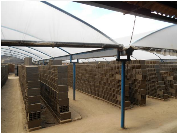
Figura 01: Estufa para secagem dos tijolos
