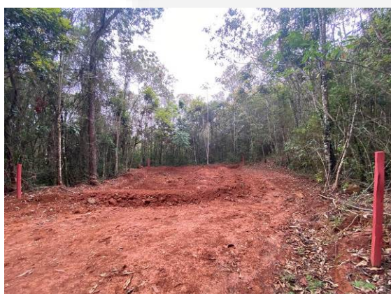
FOTO 5: Mina Retiro Branco: área de lavra, limite é demarcado com estacas.
