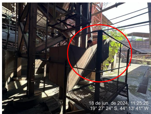
Foto 66: Parte do sistema que direciona lama do lavador de gases
