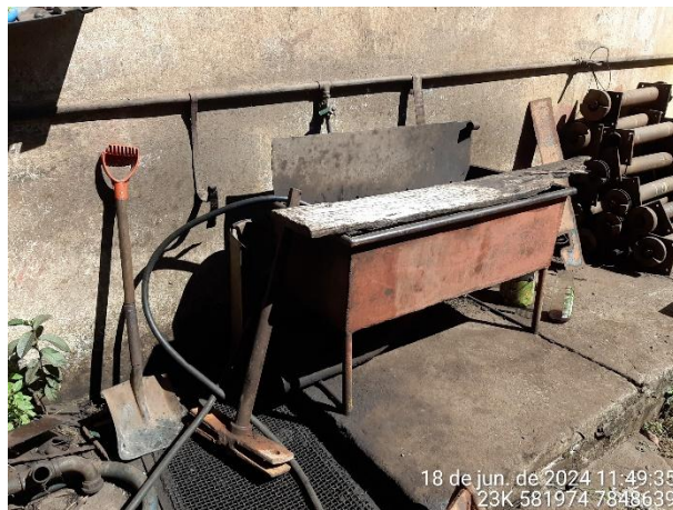
Foto 50: Tanque de lavagem de peças.
