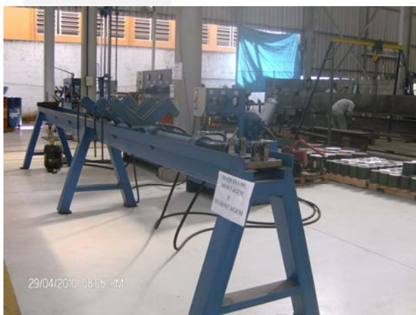
Foto 03. Bancada de montagem e desmontagem de cilindros
