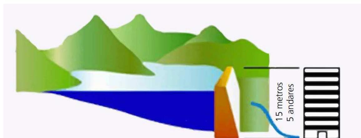
Altura do maciço da barragem  $\geq 15\text{m}$
