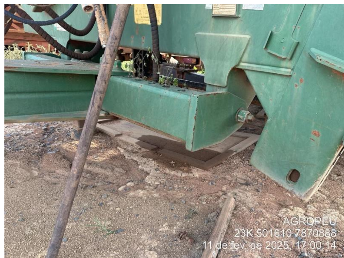
Foto 54: Vazamento de óleo em máquina disposta no pátio de sucatas.
