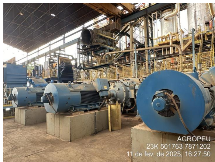
Foto 6: Redutores rotacionais que subsidiam a etapa da redução.
