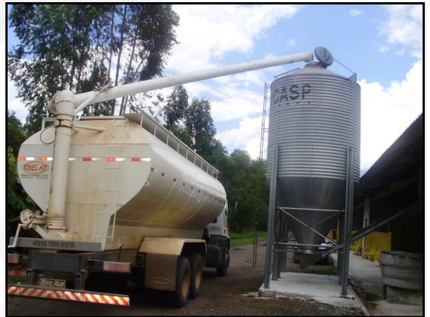
Foto 10. Transferência de ração do caminhão para o silo
