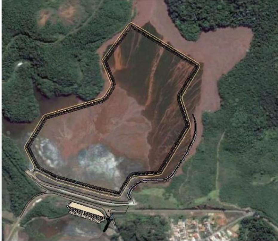
Figura 11 – Lavra do Reservatório da Barragem de B4 (Cerca de 2 Mm 3 )
