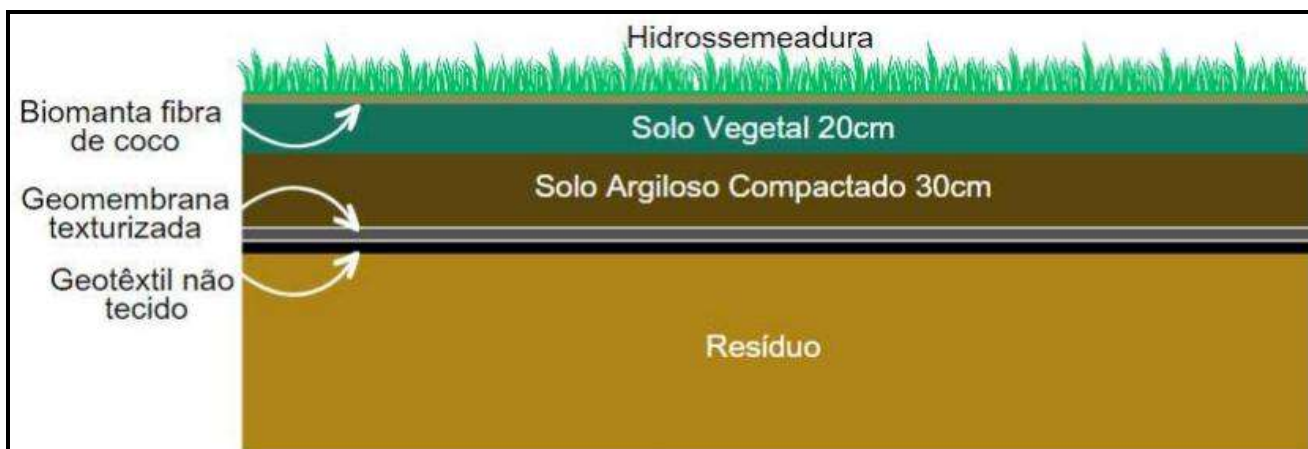
Imagem 14: Detalhamento do cobrimento dos taludes e cristas.
