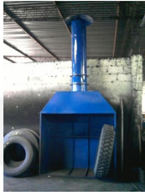
Foto 9. Cabine para cola
