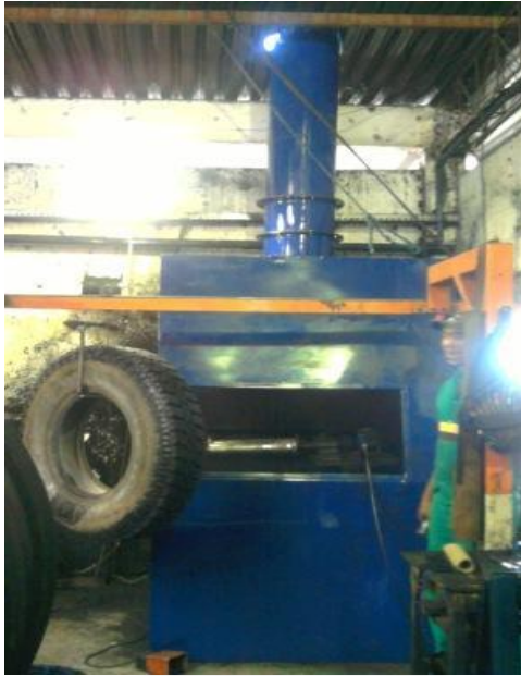
Foto 8. Cabine para pintura
