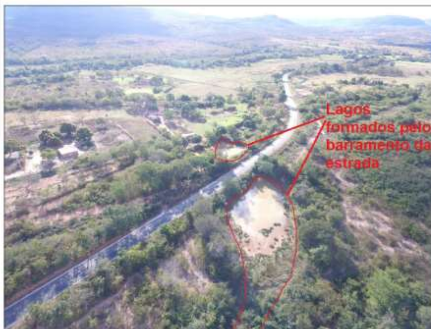
Figura 7 – Detalhe dos lagos formados pelo barramento da estrada da produção no rio efêmero
