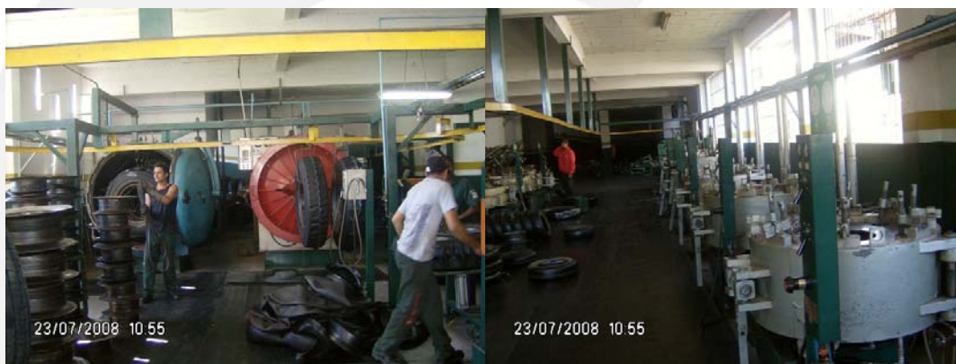
Foto 4- Vulcanização dos pneus em autoclaves e prensas.
