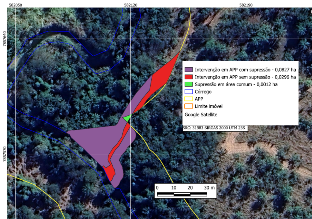
Figura 13: Identificação das intervenções ambientais requeridas para adequações do sistema de drenagem pluvial no local do lançamento final no córrego Vargem do Tropeiro. Fonte: Elaborada a partir de arquivos vetoriais apresentados pelo empreendedor – documento SEI 117919756 - sobre imagem de satélite do programa Google Earth Pro.
