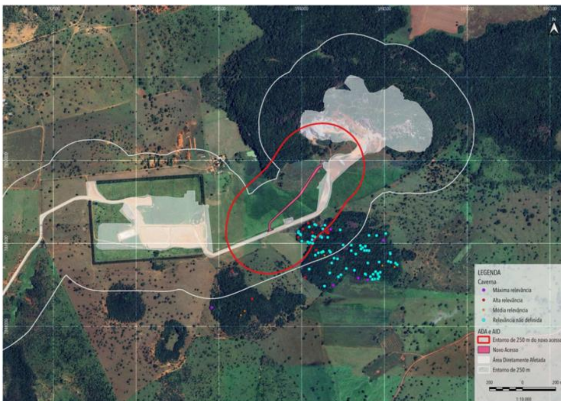
Figura 02: Novas cavidades identificadas no maciço do Escrivânia em azul e proposta de estrada alternativa deferida em Adendo ao PU.
